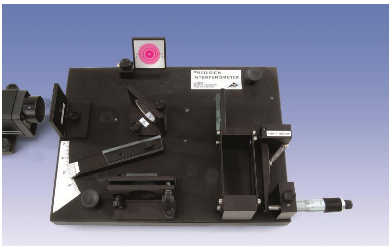
Fig.1: Messaufbau zur Bestimmung der Brechzahl von Glas mit einem Michelson-Interferometer
