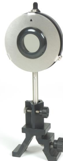
Fig. 1: Auf der Viertelwellenlängenplatte montierter Polarisationsaufsatz.
