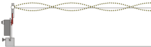
Stehende Welle ( n = 3 ) bei Reflexion am freien Ende
