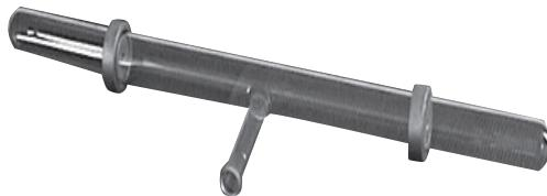
Die Entladungsrohre dient zur Beobachtung der Leuchterscheinungen bei elektrischen Entladungen in Gasen bei vermindertem Druck sowie zur Untersuchung von Katoden- und Kanalstrahlen, die bei niedrigem Druck außerhalb der Entladungsstrecke auftreten.
