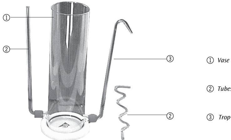
Le vase avec les trois tubes en verre permet d'illustrer le niveau d'eau dans des vases communicants, mais peut aussi être utilisé comme réservoir de trop-plein pour déterminer le volume et la densité de corps solides.
