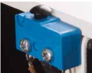
Рисунок 4. Концевой выключатель безопасности 1
