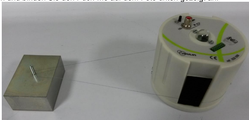
An einen Stift angebundener Inkjet-Puck zur Beschreibung einer kreisförmigen Bewegung
