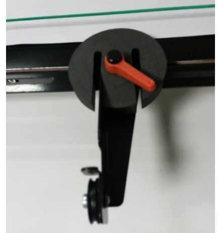
Umlenkrolle an einer der mitgelieferten Tischhalterungen montiert (Draufsicht)
