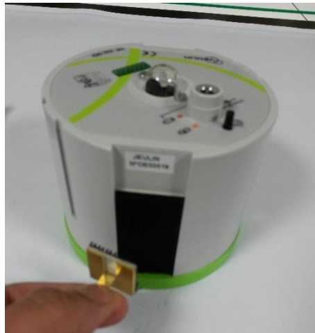
Ansatzstück mit Klettverschluss zur Befestigung am Puck
