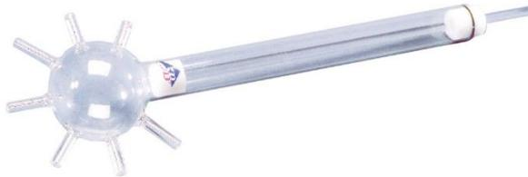
Das Druckausbreitungsgerät dient zur Demonstration der gleichmäßigen Druckverteilung in Flüssigkeiten nach allen Richtungen.
