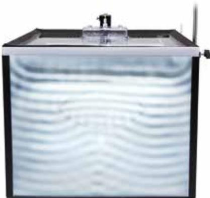
Brechung von Wasserwellen an einer Sammellinse
