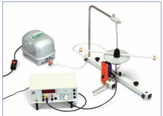
Messung der Schwingungsdauer und Bestimmung des Trägheitsmoments
