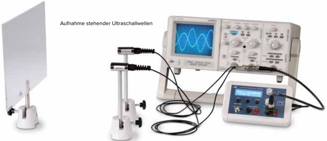
**Gerätesatz Ultraschallwandler 40 kHz**
