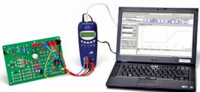
Kennlinie einer Z-Diode
