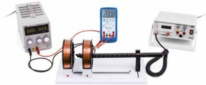
Messung des Magnetfeldes an einem Spulenpaar mit variablem Abstand
