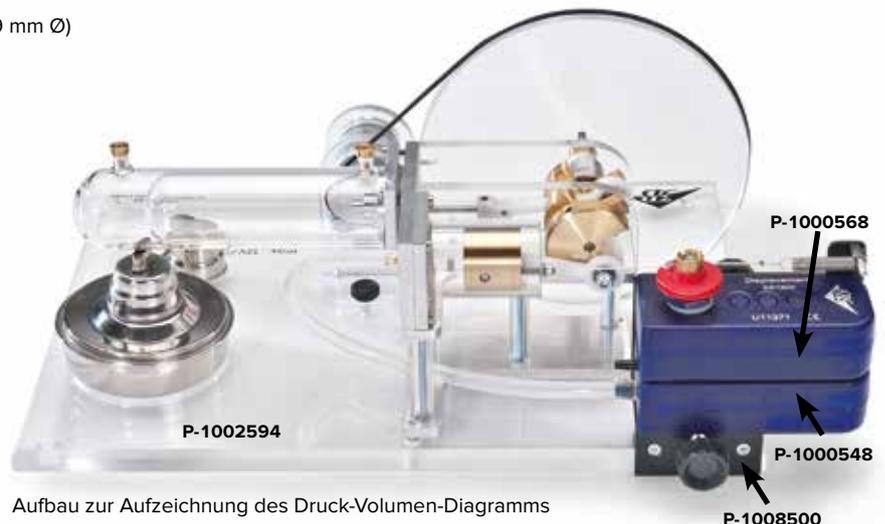
Aufbau zur Aufzeichnung des Druck-Volumen-Diagramms
