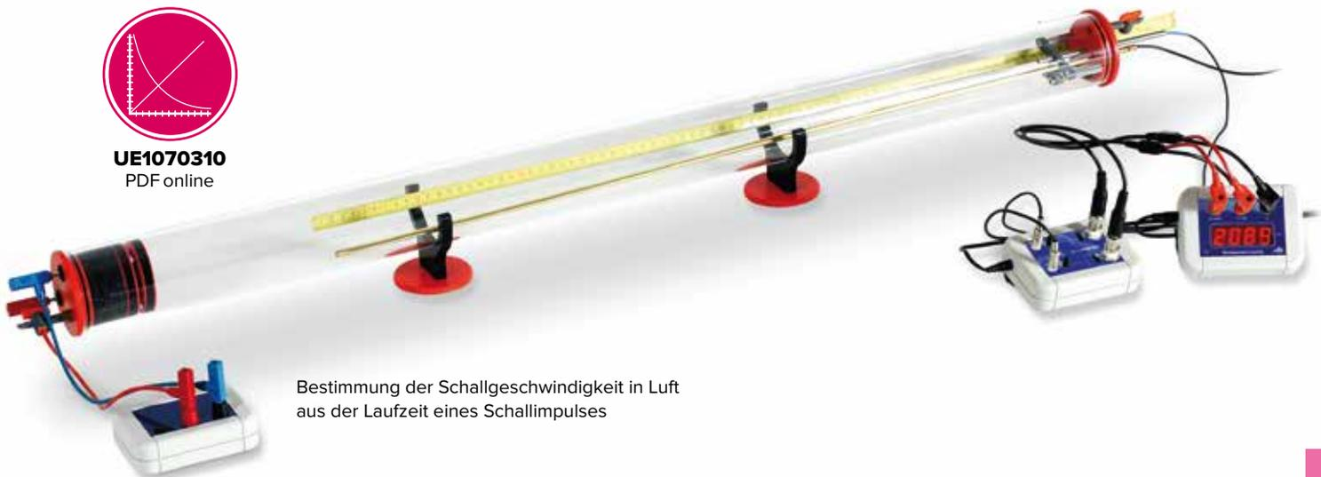
Bestimmung der Schallgeschwindigkeit in Luft aus der Laufzeit eines Schallimpulses
