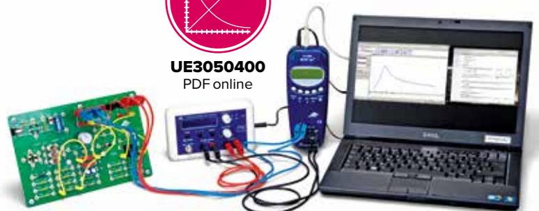
Aufzeichnung der Resonanzkurve eines RLC-Serienschwingkreises
