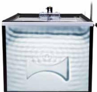
Reflexion von Wasserwellen an einem „Hohlspiegel“
