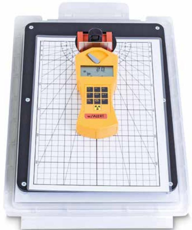
Ablenkung von Alpha- und Betastrahlung im Magnetfeld
