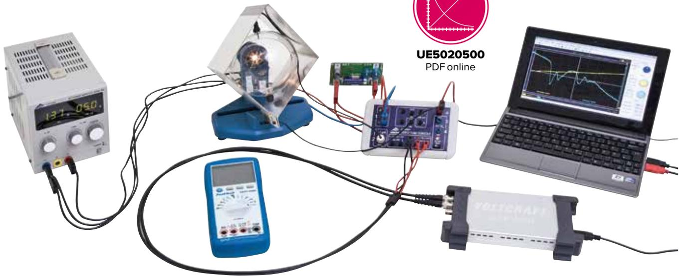
Experimenteller Aufbau mit der Steuereinheit für Kritische-Potenziale-Röhren
