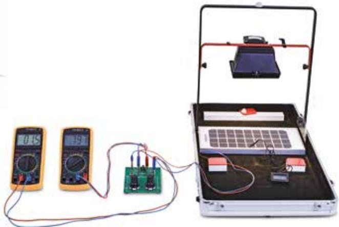
Temperaturabhängigkeit der Leistung von Solarmodulen
