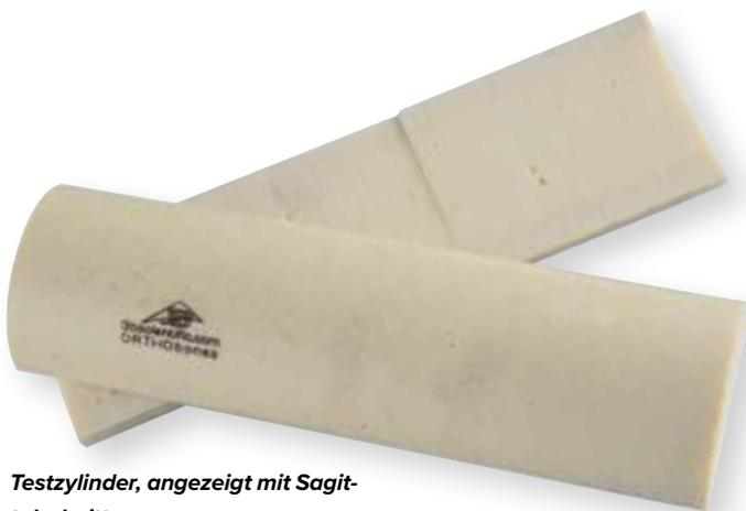
Testzylinder, angezeigt mit Sagittalschnitt
