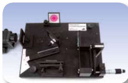
Glasplatte im Strahlengang des Michelson-Interferometers
