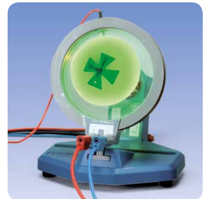
Abb. 2: Drehung des Elektronenschattens durch Ablenkung der Elektronen im axialen Magnetfeld
