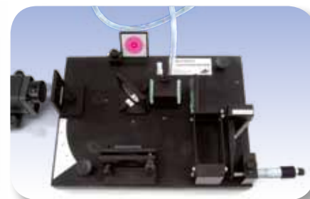
Evakuierbare Kammer im Strahlengang des Michelson-Interferometers
