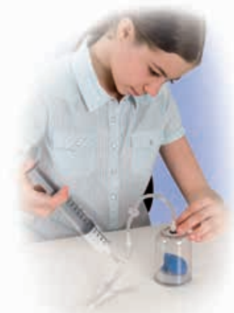
Wirkung des Luftdrucks auf einen geringfügig aufgeblasenen Luftballon
