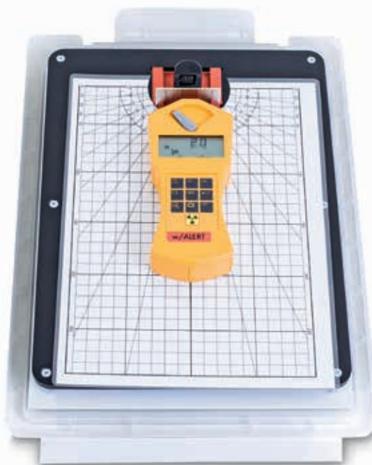
Absorption der Beta-Strahlung des Thoriumstrahlers
