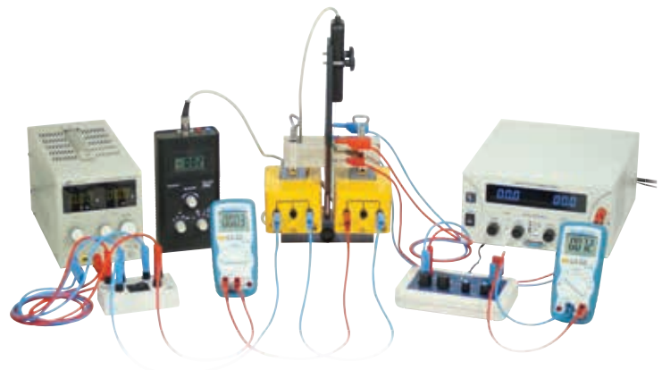
Experimenteller Aufbau: Hall-Effekt an Metallen
