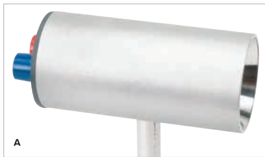
Messung der Wärmestrahlung eines Leslie-Würfels
