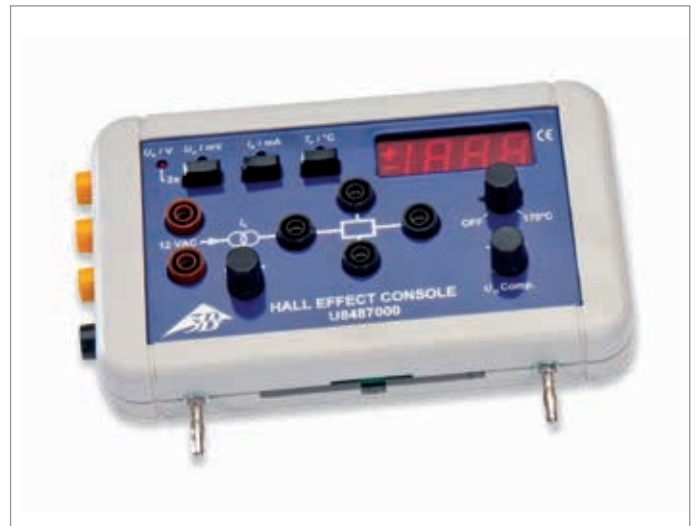
Experimenteller Aufbau: Elektrische Leitung in Halbleitern
