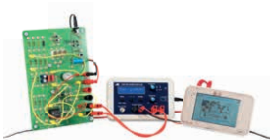
Aufzeichnung der Resonanzkurve eines RLC-Serienschwingkreises
