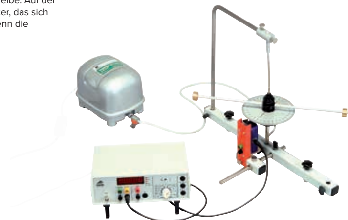
Messung der Schwingungsdauer und Bestimmung des Trägheitsmoments
