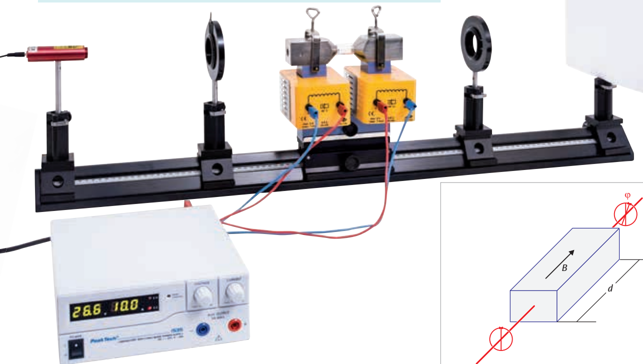
Schematische Darstellung zur Erläuterung des Faraday-Effekts
