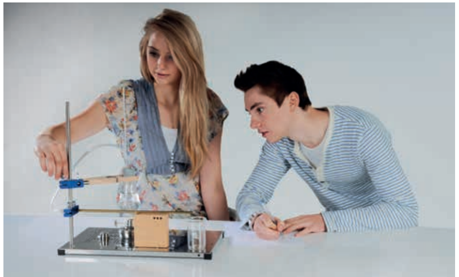
Längenänderung fester Körper bei Erwärmung
