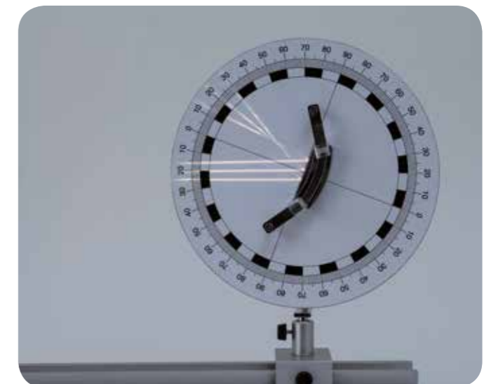
Abb. 3: Reflexion dreier paralleler Strahlen am Hohlspiegel
