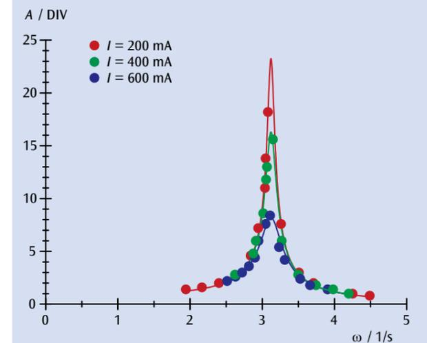
Abb. 1: Resonanzkurven bei verschiedenen Dämpfungen
